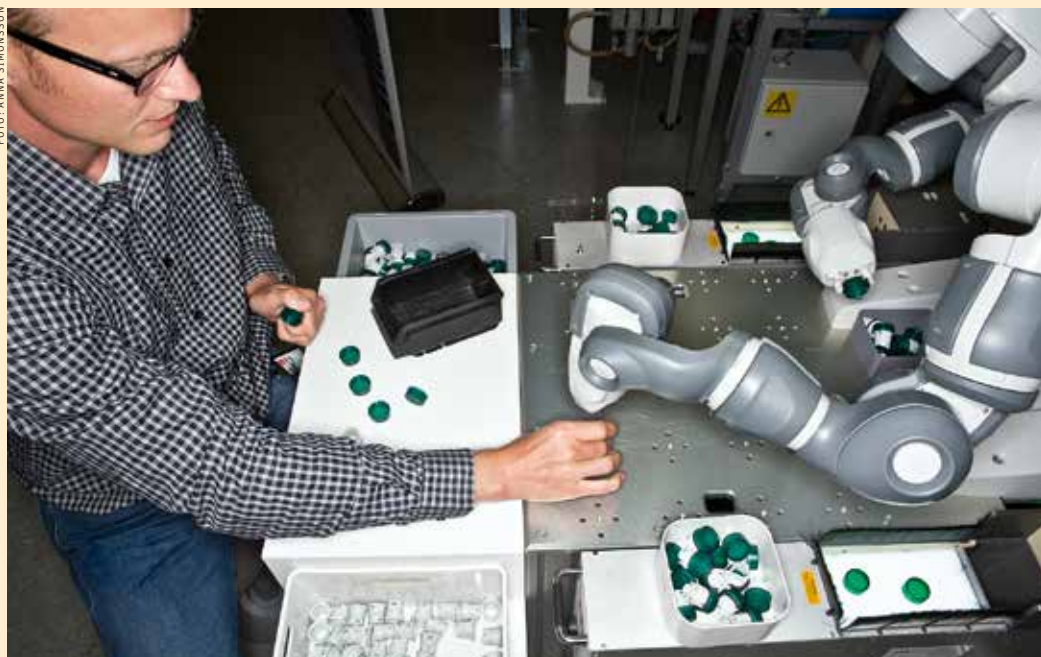
SAMARBETE. Ivan Lundberg trär en gummipackning på kapsylen och roboten YuMi använder båda "händerna" för att snabbt plocka upp den och gänga på ett lock.
