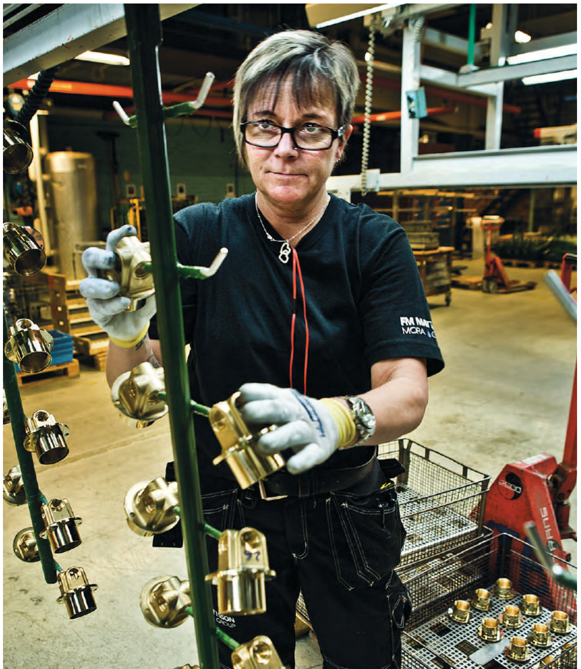
GALGNING. Kristina Dufva hänger upp gjutna delar som ska ytbehandlas.
